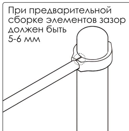
Сборка элементов с помощью хомутов производится на отдельно подготовленной поверхности, чтобы не повредить лако-красочное покрытие.
