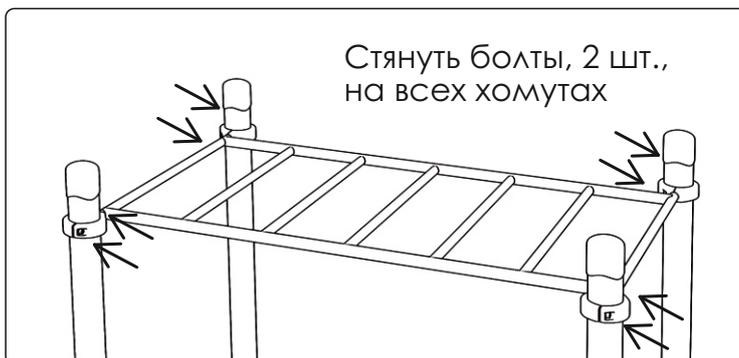
Шведская стенка E-012 размещается между столбами, и закрепляется на столбах с помощью четырех хомутов. ▷
