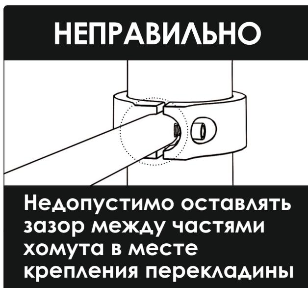
**ПРЕДЕЛЬНЫЙ МОМЕНТ ЗАТЯЖКИ РЕЗЬБОВОГО СОЕДИНЕНИЯ ХОМУТА ПРИ МОНТАЖЕ = 40-45 Нм**
