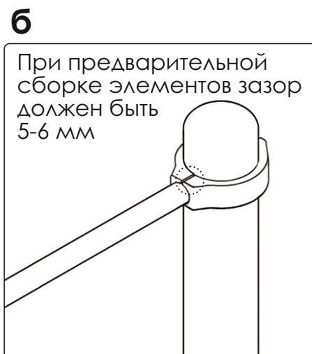
Сборка элементов с помощью хомутов производится на отдельно подготовленной поверхности, чтобы не повредить лако-красочное покрытие.
