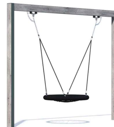
Качели состоят металлической рамы высотой 2470 мм и длиной 3300 мм и подвеса гнездо диаметром 1000 мм. Элементы крепятся к опорным столбам болтовыми соединениями. Высота фиксации подвеса гнездо - не менее 500 мм от нижнего края до уровня земли. Длина качелей не более 3300 мм.
