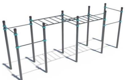
Комплекс состоит из десяти опорных столбов высотой 2600 мм, шести перекладин для подтягиваний длиной 1200 мм и двух секций рукохода. Элементы крепятся к опорным столбам при помощи хомутов. Высота фиксации перекладин для подтягиваний: 2 шт. – 2400 мм, 1 шт. – 2250 мм, 1 шт. – 2100 мм, 2 шт. – 1800 мм. Высота фиксации секций рукохода: 1 шт. – 2150 мм и 1 шт. – 2450 мм. Длина каждой секции 1900 мм. Шаг рукохода 310 мм. Длина комплекса не более 6500 мм.
