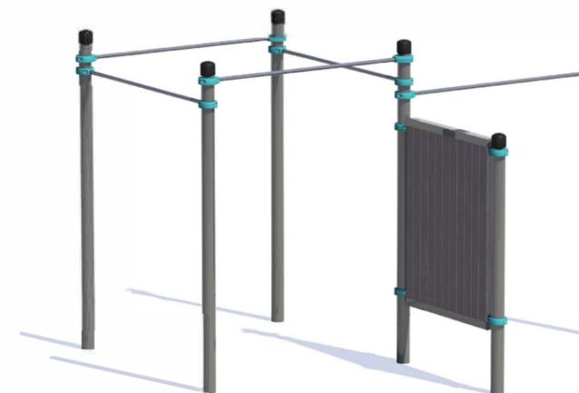
Комплекс состоит из шести опорных столбов высотой 1 шт. - 2000 мм, 5 шт. - 2600 мм, пяти перекладин длиной 1758 мм и одной стенки размером 1100x1500 мм из древесно-полимерного композита. Стенка крепится на две перекладины длиной 1200 мм, на высоте 1950 мм от поверхности основания. Элементы крепятся к опорным столбам при помощи хомутов. Высота крепления перекладин: 1 шт. - 2200 мм, 2 шт. - 2300 мм, 1 шт. - 2400 мм, 1 шт. - 2450 мм. Длина комплекса не более 3840 мм
