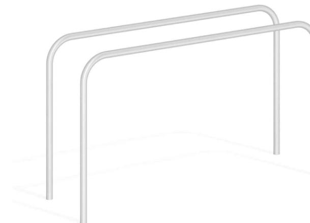
Комплекс состоит из двух жердей. Жерди брусьев расположены параллельно. Расстояние между внутренними поверхностями жердей 500 мм, рабочая поверхность - 1800 мм. Жерди брусьев симметрично изогнуты под углом 90 градусов, высота - 1200 мм от поверхности основания. Длина комплекса не более 2100 мм.
